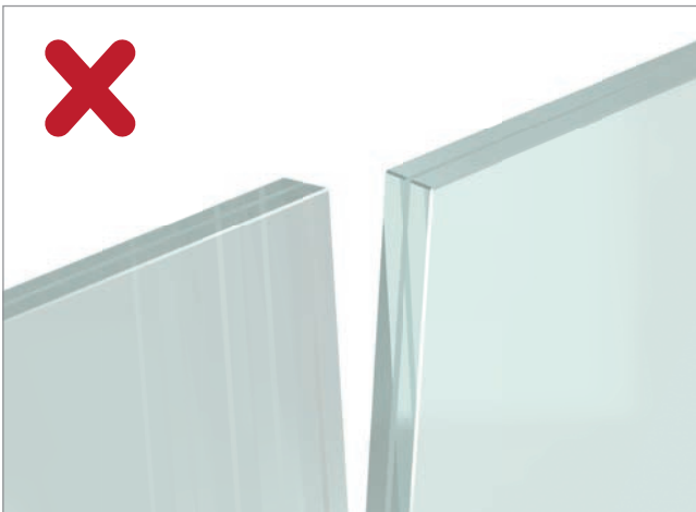
zum Ausrichten der Scheiben ohne Handlauf
