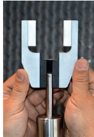
Montagevorrichtung ist fertig präpariert und wird durch Aufschieben mit dem Trägerpin verbunden
