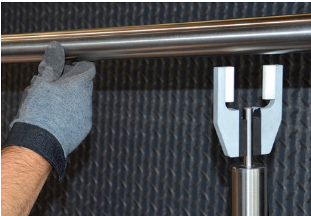
Handlauf in die Vorrichtung einsetzen
